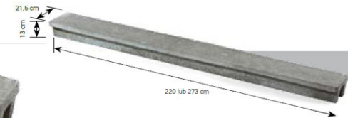
Belka podwalinowa (zbrojona) symbol: D3 (220 cm) waga: ok. 80 kg symbol: D3 (273 cm) waga: ok. 95 kg
