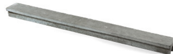
D3 Belka podwalinowa 220 (zbrojona) wys. 12 cm dł. 220 cm szer. 21,5 cm
